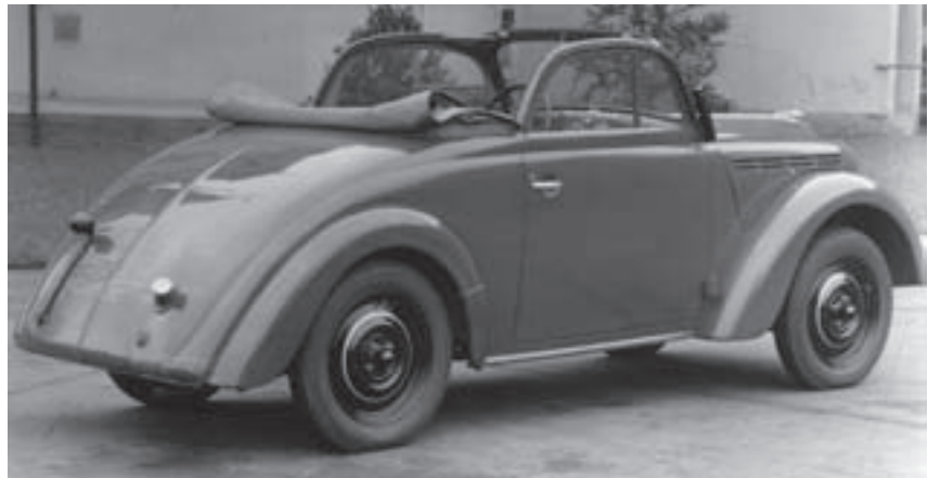
Nur von außen zugänglich, aber groß und praktisch: der Kofferraum. Das aus einem Stück gefertigte Heck trägt maßgeblich zur Stabilität der selbststragenden Karosserie bei
